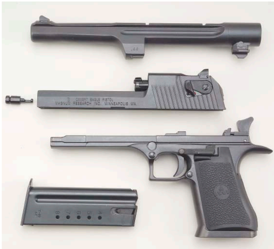
Einfache Demontage. Der Wüstenadler lässt sich in wenigen Sekunden komplett ohne Werkzeug zerlegen. Der Lauf trennt sich bereits beim Herabschwenken des Demontagehebels vom Rest der Pistole.
