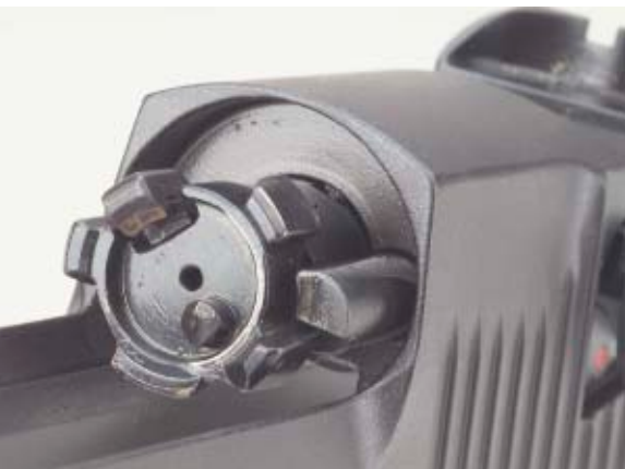
Einblick. Der Drehwarzenverschluss mit gefederter Auswerfer im Stoßboden.
