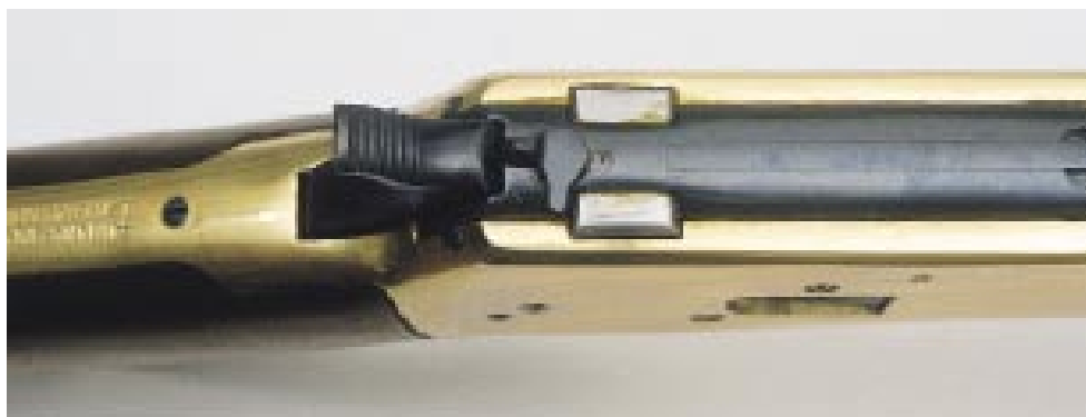
Zweifach gesichert: Blick auf die auf dem Verschlussstück sitzende zusätzliche Sicherung. Sie verhindert, dass der Hahn den Schlagbolzen in gesicherter Stellung nach vorne bewegen kann.
