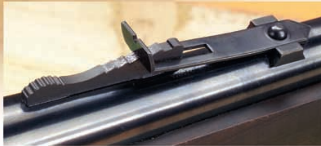
Schnörkellos: Statt der originalgetreuen Buckhorn-Kimme kommt der Puma mit einfacher U-Kimme. Die treppenartige Visierverstellung entspricht der Preisklasse und dem Vorbild.
