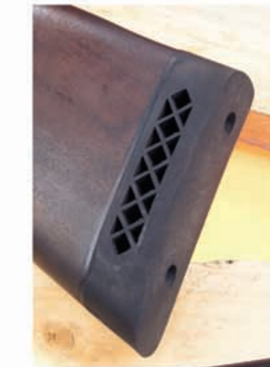
Knutzone: Der dicke Gummipuffer am Schaft macht sofort deutlich, daß hier eine kräftige Patrone ins Patronenlager gehört.
