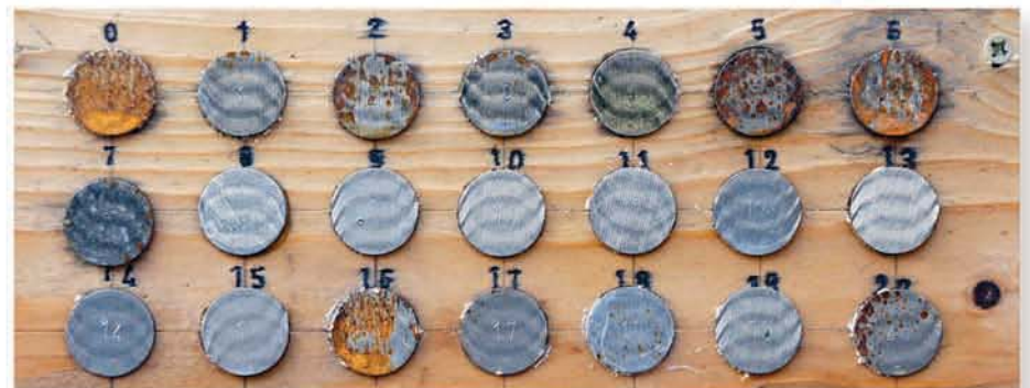
Nach zwei Tagen konnte man beobachten, dass die Scheiben mit den Waffenpflegemitteln Nummer 2, 5, 6 und 16 schon deutlich Rost ansetzten. Mit so einem Mittel kann man seine Waffe also nicht über einen längeren Zeitraum schützen.
