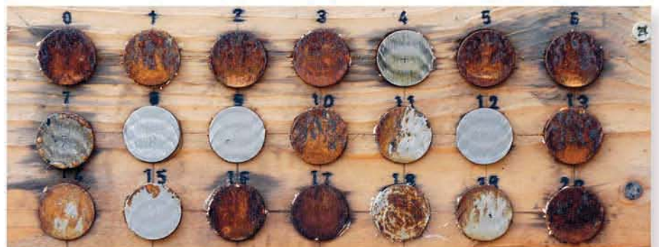
Nach 12 Tagen ist für die meisten Mittel die Belastungsgrenze längst erreicht beziehungsweise überschritten. Der Rost hat gesiegt. Nur die vier Produkte mit den Nummern 4, 8, 9 und 12 überstehen die Tortur mühelos.
